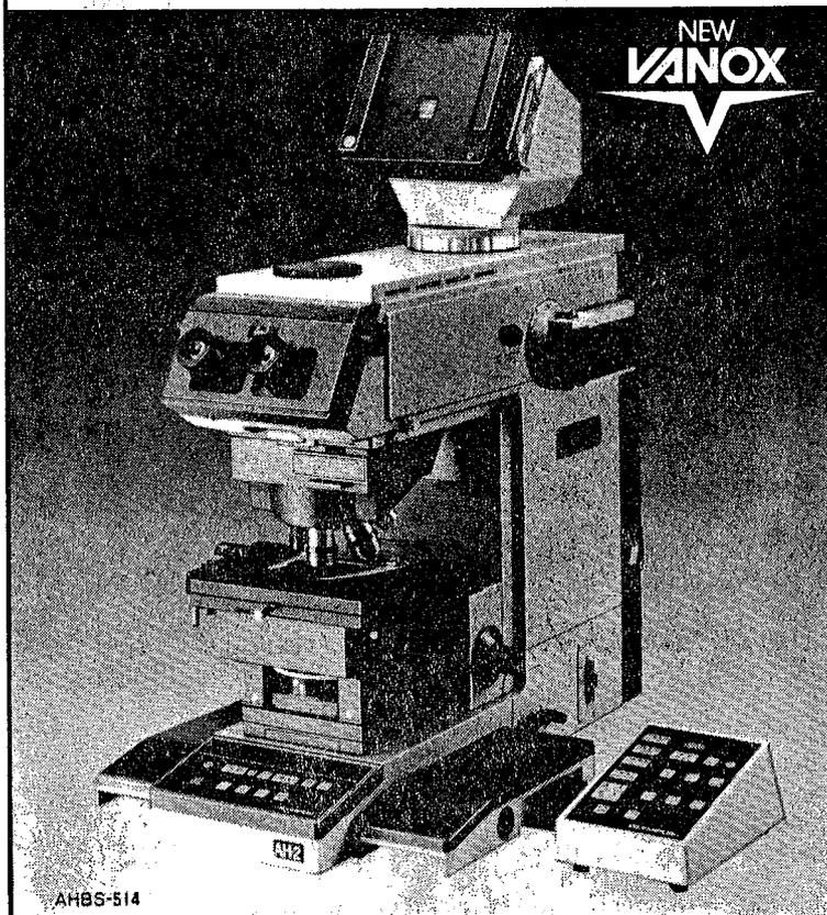
全自動写真撮影装置を内蔵。今までにない多様なシステム性と操作性で画像解析、分光測光などの将来的研究ニーズにも充分対応。電動6ヶ穴レボルバー、1×~100×まで完全ケラー照明、写真撮影レンズ4種類内蔵、フィルム面と同じ像が観察できる一眼レフ式ファインダー、視野数26.5φの超広視野など随所に最先端のメカニズムが生きています。しかも、35mm2台+大版1台+TVカメラ1台計4台を同時装着できる3-WAYカメラ。鮮明な像を観察、確実に記録できます。
