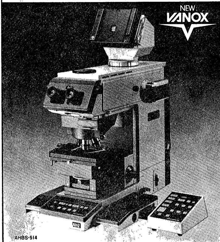
全自動写真撮影装置を内蔵。今までにない多様なシステム性と操作性で画像解析、分光測光などの将来的研究ニーズにも充分対応。電動6ヶ穴レボルバー、1×~100×まで完全ケラー照明、写真撮影レンズ4種類内蔵、フィルム面と同じ像を観察できる一眼レフ式ファインダー、視野数26.5φの超広視野など随所に最先端のメカニズムが生きています。しかも、35mm2台+大版1台+TVカメラ1台計4台を同時装着できる3-WAYカメラ。鮮明な像を観察、確実に記録できます。
